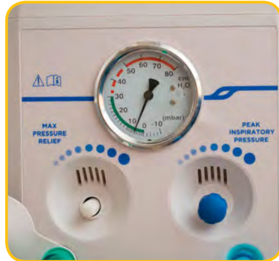
شکل ۴الف. ۱۰ PEEP را تنظیم کنید
