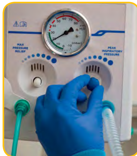
شکل ۴الف. ۹. فشار حداکثری دمی را تنظیم کنید
